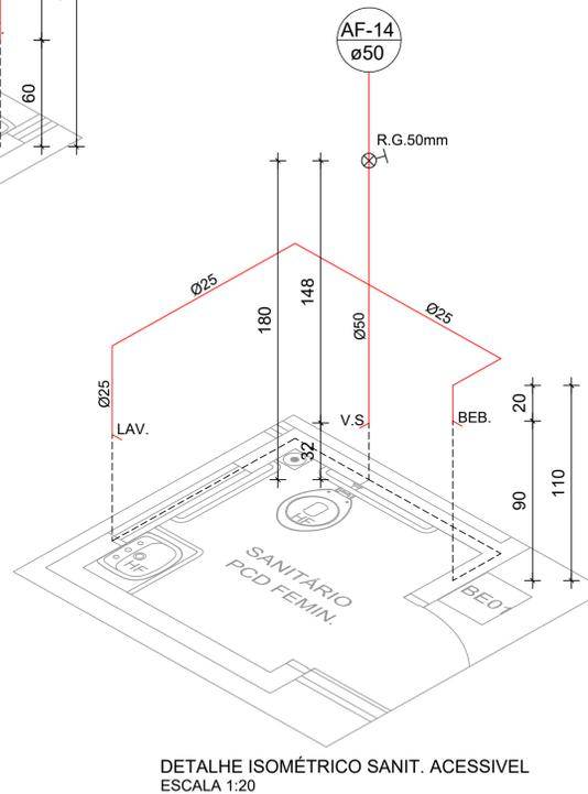
DETALHE ISOMÉTRICO SANIT. ACESSÍVEL
