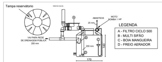
RESERVATÓRIO PARA APROVEITAMENTO DE ÁGUA PLUVIAL
